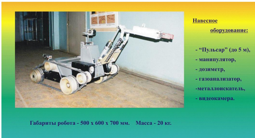
*Рис. 2. Многофункциональный робот, обеспечивающий обследований зон возможных террористических воздействий и нейтрализацию взрывчатых и отравляющих веществ.*
