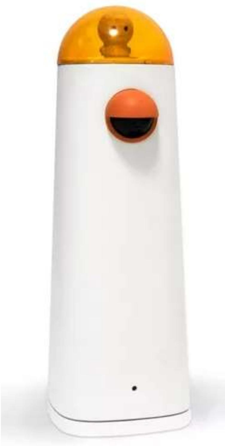
**Command Tower** - это башня с встроенной камерой для распознавания программы, составленной из блоков. Настоящий командный центр. Распознав программу, она передает ее в MatataBot для выполнения.
