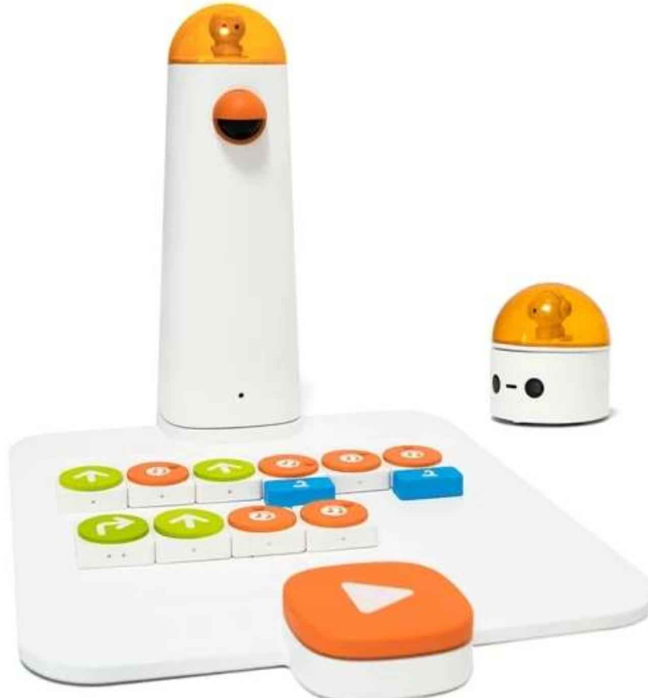
**Control Board** – расположите на ней MatataBlocks, что бы задать программу для исполнения роботом MatataBot. Нажмите кнопку со стрелкой для распознавания программы и передачи ее на исполнение роботу.
