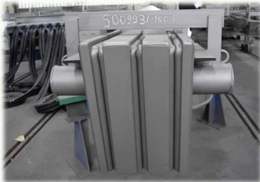
Устройство окаймления для отвода воды и защиты конструкции шва
