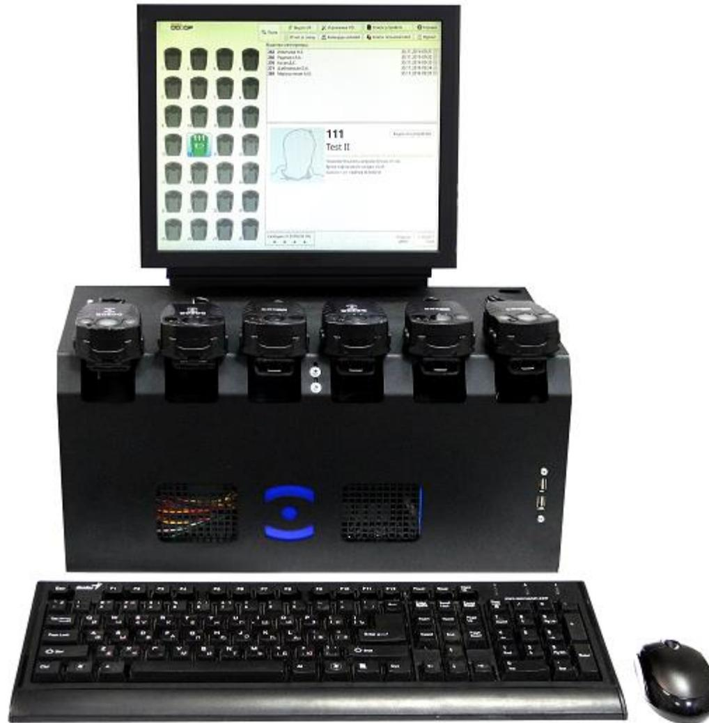
**Настольный терминал архивирования и подзарядки на 6 (12 при посменной работе) устройств для настольного использования**
