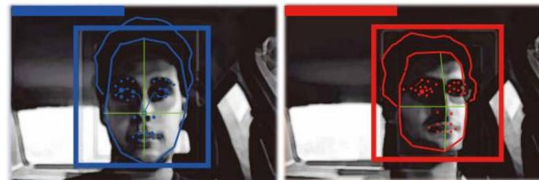
Камера анализирует перемещение сетки, спроецированной на лицо. В случае детектирования опасной ситуации, формируется сообщение для передачи в устройство мониторинга. Одновременно из камеры поступает звуковой сигнал для привлечения внимания водителя.
