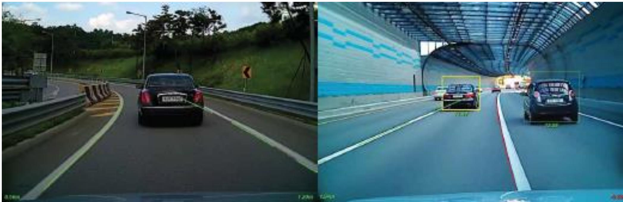
Во время движения устройство распознает параллельную разметку, прерывистую или сплошную, а также постоянно следит за соблюдением бокового интервала и пересечении линии разметки без включенного указателя поворота. При опасном приближении к линии разметки или пересечении ее без указателя поворота, устройство сигнализирует водителю и формирует тревожно сообщение для отправки на сервер.
