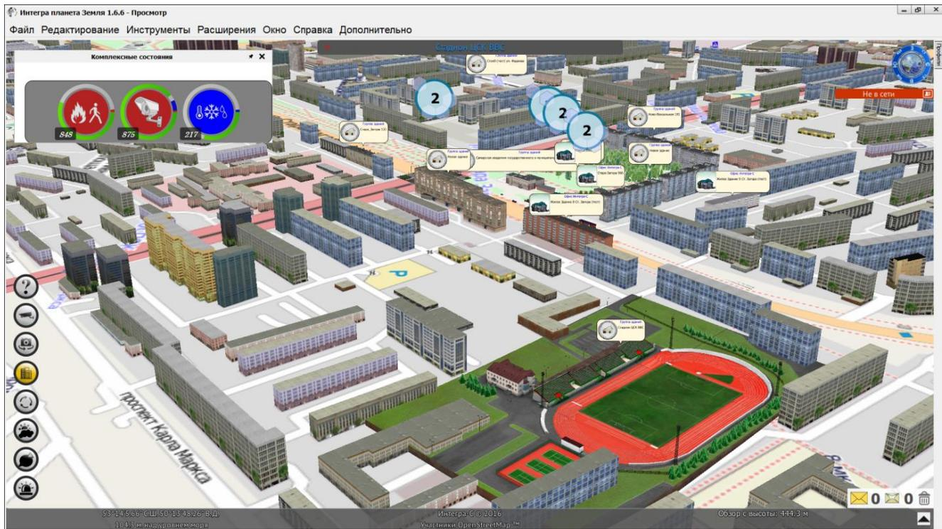
Визуализация состояния объектов и территорий в 4D ГИС исполнении с привязкой всех компонентов системы мониторинга (видеокамер, датчиков, приборов и др.) к географическим координатам Земли и времени.
