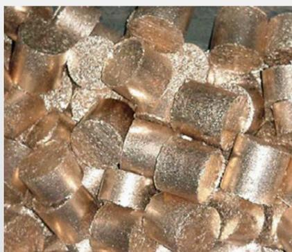
**ПЕРЕПЛАВ СТРУЖКИ В ИНДУКЦИОННЫХ КАНАЛЬНЫХ ПЕЧАХ СТАЛ ВОЗМОЖЕН БЛАГОДАРЯ БРИКЕТИРОВАНИЮ**
