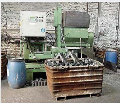
**БРИКЕТИРОВАНИЕ РАЗЛИЧНЫХ СОРТОВ ЧУГУННОЙ СТРУЖКИ СНИЗИЛО ПРОИЗВОДСТВЕННЫЕ ЗАТРАТЫ**
