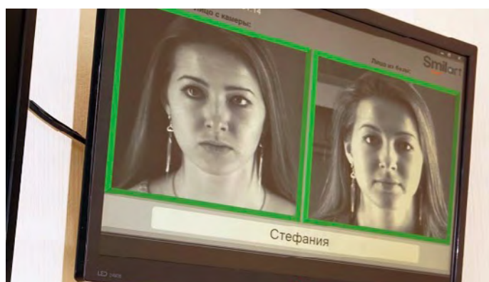
На мониторе отображается полученное изображение и соответствующее ему изображение из базы данных.
