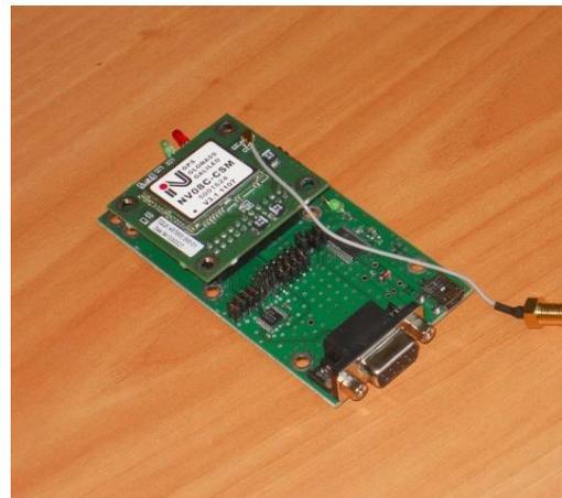
Модуль с NV08C-CSM, КБ Навис
