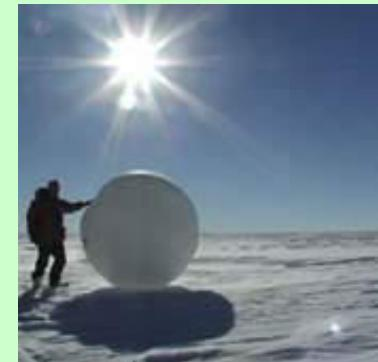
NASA испытало вездеход в форме шара, для исследования марса. Вездеход за 8 дней преодолел 70 км по плато в Антарктиде. Самое главное – у этого вездехода **нет двигателя**.
