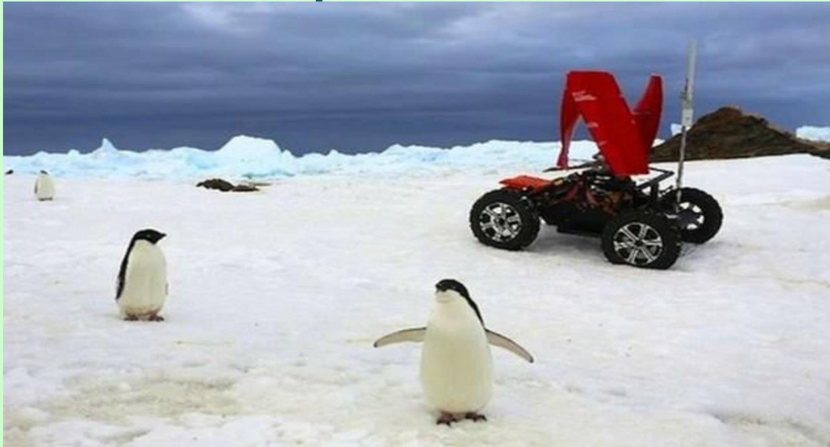
Вездеход Polar Rover, его электропитание обеспечивает ветряная турбина.
