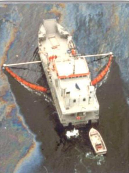
Скорость обработки пятна это **ключевой** фактор определяющий эффективность механической уборки
