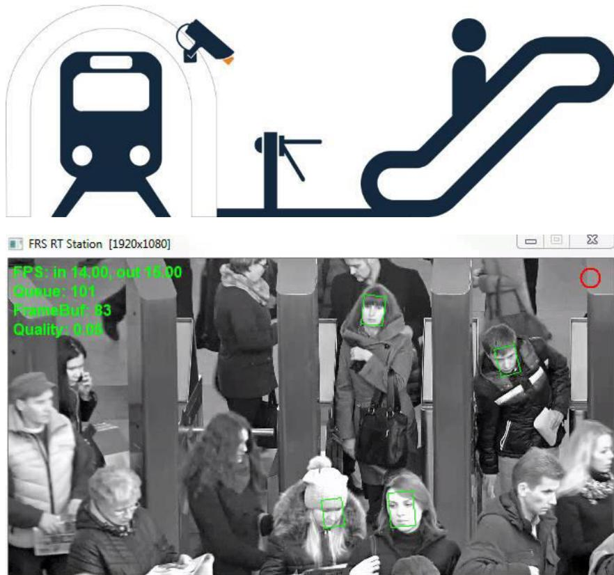
1 Видеокамера, установленная в переходах, в зонах турникетов и досмотра пассажиров, выхватывает изображение лица из видеопотока и передает его для идентификации на сервер
