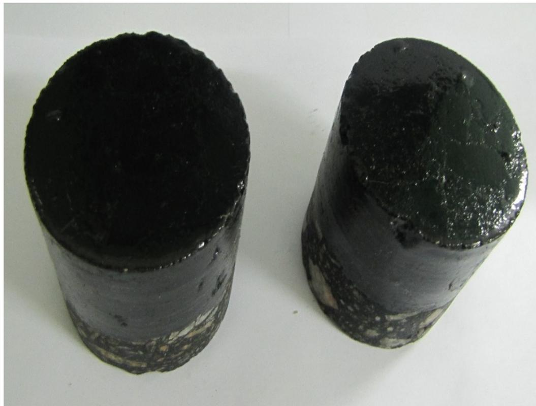
Общий вид образцов, обработанных пропиткой ASP, после испытания на истираемость на круге ЛКИ-3.
