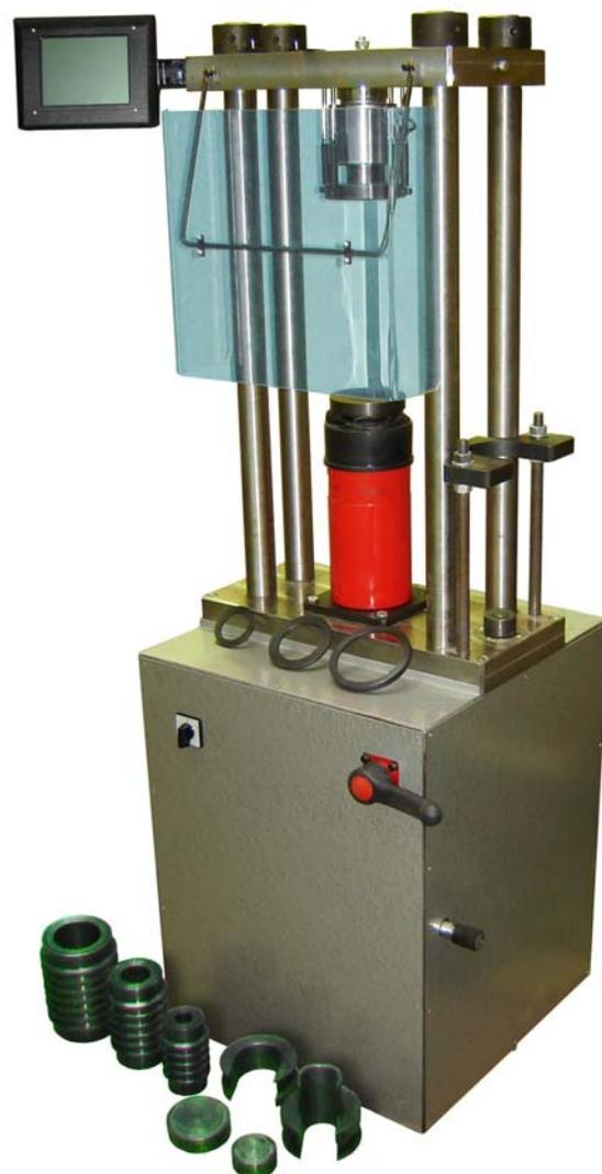
Машина имеет прочную раму увеличенных размеров, обеспечивая тем самым повышенную устойчивость и прочность. Она проста в обслуживании и предназначена для контроля качества материалов при дорожном строительстве. Для измерения величины нагрузки используются современные цифровые блоки с микропроцессорами, обеспечивающие:
