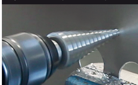
Улучшенное центрирование и засверливание
