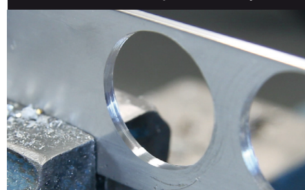
Сильно сниженное образование заусенцев
