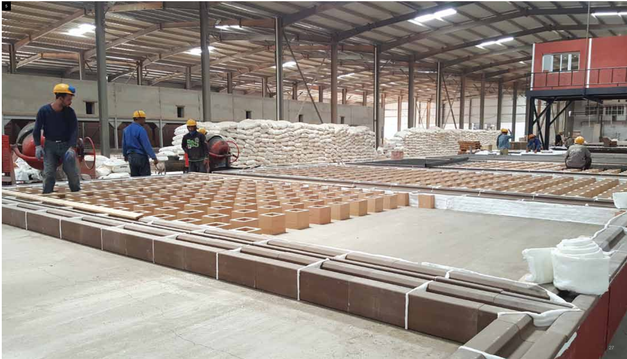
5 | Low-density kiln car (overview) (SARL BMAL – Algeria) Печная вагонетка с низкой объемной плотностью (общий вид) (SARL BMAL – Алжир)
